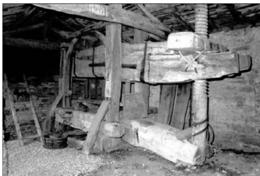
FIGURA 73. Prensa de biga amb estructura travada, localitzada a Domaine du Vernay a Mazille (Saône-et-Loire, Bourgogne, França) (segons Lauvergeon, 2004: 20, fig. 20). Fotografia: J.L. Duthu @Inventaire général, ADAGP, 2001.
