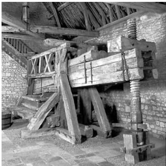
FIGURA 74. Prensa de biga amb contrapès fixat a terra, localitzada a Clos de Vougeot, (Costa d'Or, Bourgogne, França) (segons Lauvergeon, 2004: 6, fig. 4). Fotografia: J.L. Duthu @Inventaire général, ADAGP, 2003.
