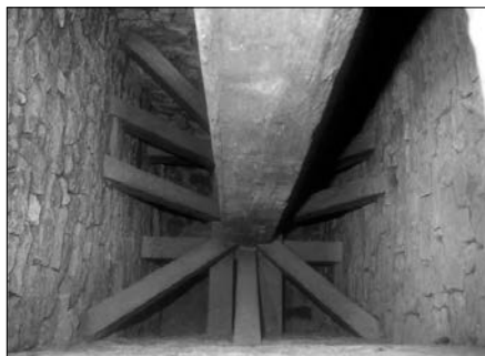
FIGURA 75. Premsa de biga del 1757 amb «taissons ancrés» localitzada a Coulanges-La-Vineuse (Yonne, Bourgogne, França) (segons Lauvergeon, 2004: 14, fig. 14). Fotografia: J.L. Duthu ©Inventaire général, ADAGP, 1998.
