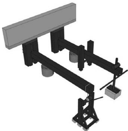
FIGURA 54. Perspectiva axonomètrica del conjunt de les dues premses de Vallmora amb tots els seus components i peces (segons Martín i Oliveras i Bayés, 2008).
